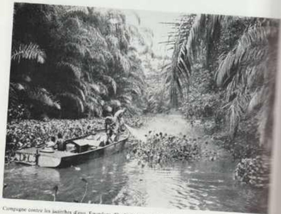
Campagne contre les jacinthes d'eau. Epandage d'herbicide, au moyen d'une pompe mécanique montée sur bateau.
